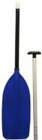
Цевье весла выполнено из дюралюминиевой трубы марки Д16Т диаметром 30x1 мм. Цевье весла отштамповано с одной стороны под конус и вставляется на всю длину лопасти при отливке. Это значительно повышает прочность весла. Весло разбирается на 2 части и при сборке соединяется кнопочным фиксатором.
